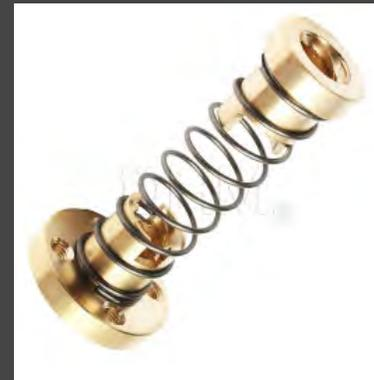
Paket enthält: 1 x Messingmutter Ø8 mm Anti-Backlash Mutter für Trapezgewinde, Durchmesser 8 mm. Wird für Präzisionsbewegungen in 3D-Druckern und kleinen CNC-Maschinen verwendet. Die Mutter ist für Trapezstangen mit 2mm Teilung mit 2 Prinzipien geeignet. Da es mit einer Feder ausgestattet ist, ist es ein hervorragendes Anti-Spiel-System, das eine beträchtliche Verringerung des Spiels der Z-Achse ermöglicht. Das Taumelphänomen wird dadurch erheblich r...
