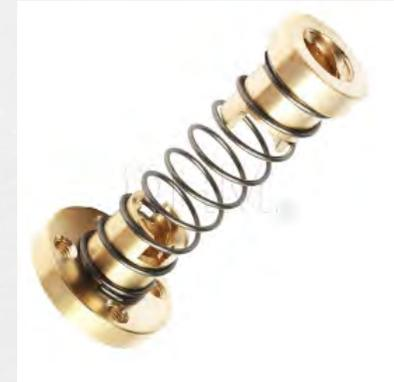
**T8 Anti-Backlash-Buchse 8 mm Trapezschraube 2 mm Steigung**
