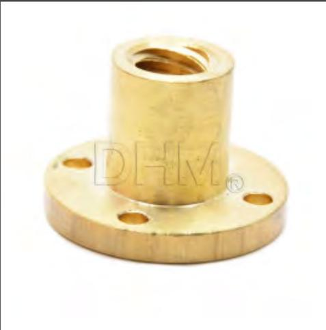
Die Packung enthält: 1 x Messingmutter Ø16 mm Steigung 3 mm 1 Prinzip Mutter für Trapezgewinde, Durchmesser 16 mm. Verwendet für Präzisionsbewegungen in 3D-Druckern und kleinen CNCs Die Mutter ist geeignet für TR16x3 Trapezstangen (Steigung 3 mit 1 Prinzip, d.h. jede Umdrehung bewegt 3 mm).
